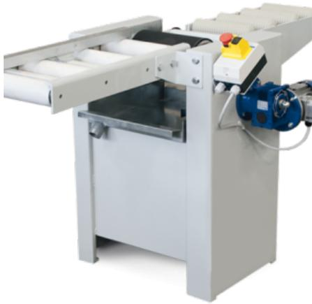
**Descrizione:** INCOLLATRICE OSAMA MOD. S1R - ad un rullo per bordi e legno massello - velocità avanzamento 28 mt./min. - rigatura passo 2 - trifase
