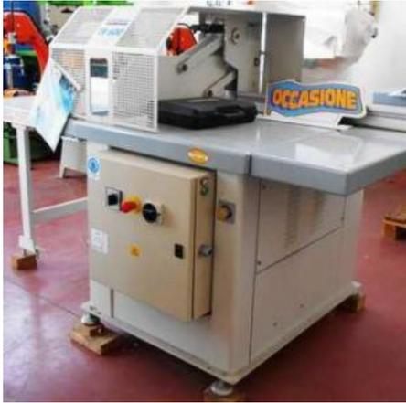
**Descrizione:** TRONCATRICE IDRAULICA STROMAB MOD. TR600 - motore hp 12,5 - lama diam. 600 - capacità a troncare sezione 420x160 o 610x30 mm. Completa di: - piano di lavoro a dx della lama - piano di lavoro a sx della lama - lama al widia - griglia di protezione su zona taglio
