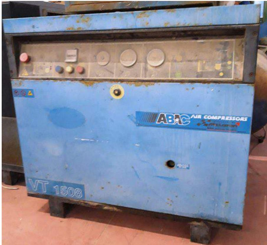
**Descrizione:** Compressore a vite Abac mod. VT 1508 - kw 11 - pressione 8 bar - aria aspirata 1,70 m<sup>3</sup>/min
