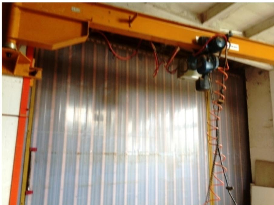
**Descrizione:** BRACCIO SOLLEVAMENTO CON VENTOSE ATA - tipo w-5 - con paranco portata kg. 200 demag - n.1 ventose a due piastre per sollevamento pannello BANDIERA con fissaggio su colonne del capannone - lunghezza bandiera mm. 4600
