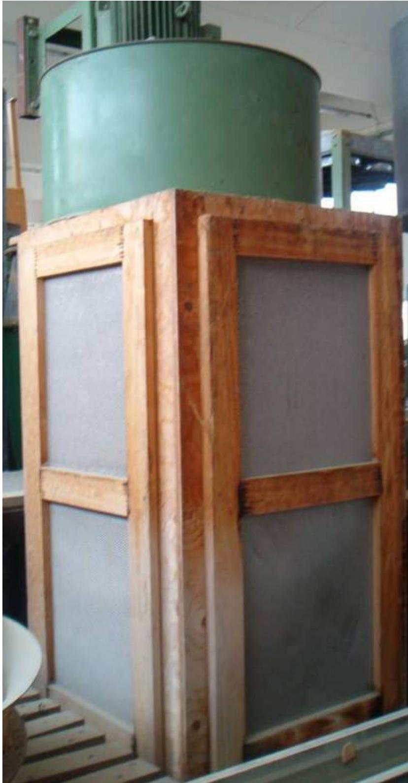
**Descrizione:** VENTILATORE MONTATO SU CASSETTA FILTRANTE PER DEPRESSIONE CABINA DI VERNICIATURA - motore HP 4 kw 3 - uscita ventilatura 35 int.x38 int.
