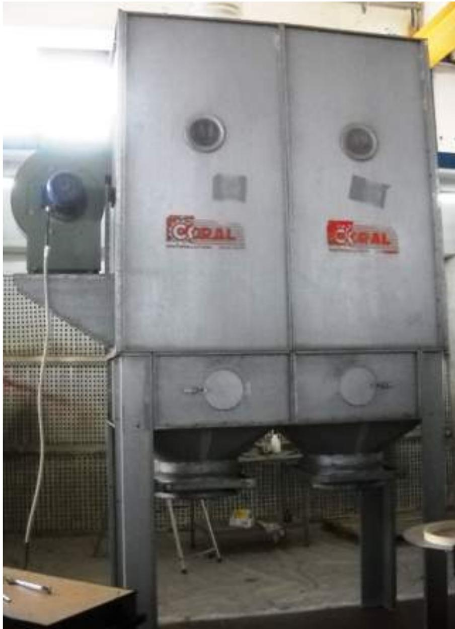
**Descrizione:** UNITA' FILTRANTE CORAL MOD. MS - lunghezza mm. 1900 larghezza mm. 1000 altezza mm. 3900 - a 2 sacchi diam. 500 mm. - carenato - motore hp 4 - sporgenza motore 80
