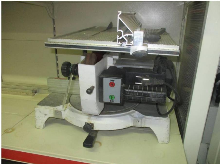
**Descrizione:** TRONCATRICE PEGIC MOD. R 300 SI - a norme CE - motore kw 2,1 monofase -
