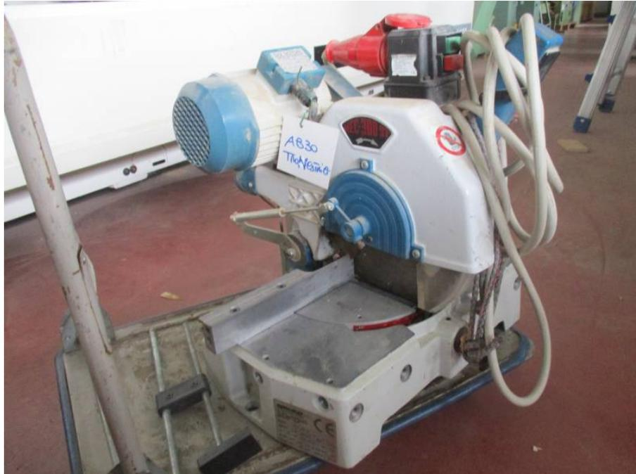
**Descrizione:** TRONCATRICE OMGA MOD. MEC 300 ST - a norme CE - motore kw 1,6 trifase - diam. max lama 300 mm.
