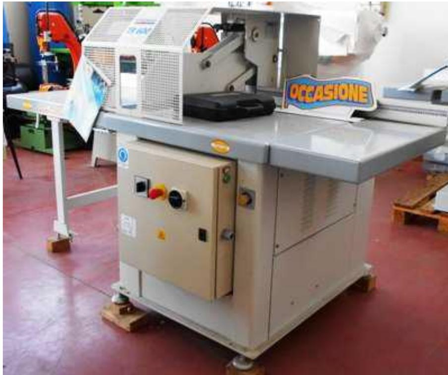
**Descrizione:** TRONCATRICE IDRAULICA STROMAB MOD. TR600 - motore hp 12,5 - lama diam. 600 - capacità a troncare sezione 420x160 o 610x30 mm. Completa di: - piano di lavoro a dx della lama - piano di lavoro a sx della lama - lama al widia - griglia di protezione su zona taglio
