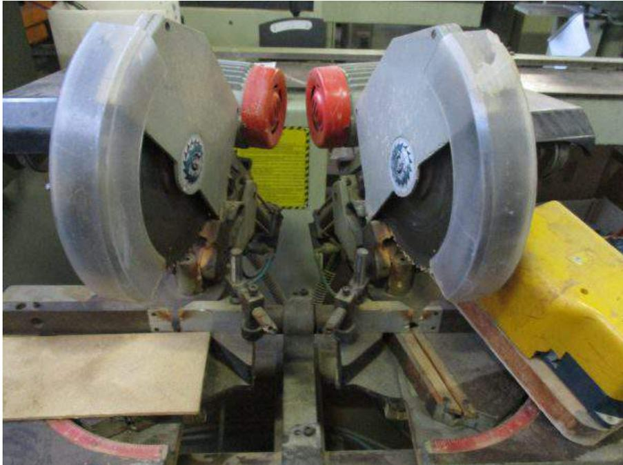
**Descrizione:** Troncatrice doppia Omga mod. TR2A - apertura mm. 2800 - lama diam. 300 - discesa pneumatica teste - motori kw 1,6 cad.
