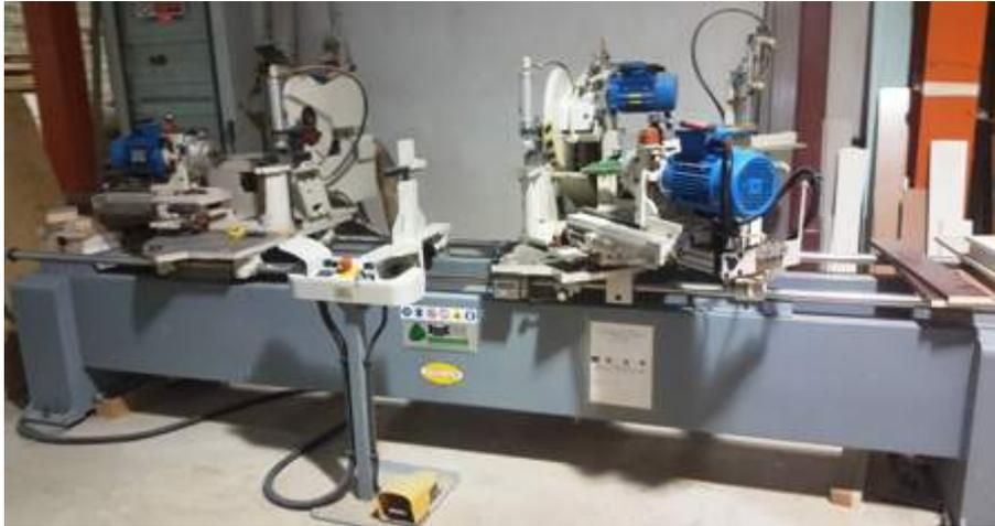
**Descrizione:** TRONCATRICE DOPPIA ESSEPIGI MOD. RAPID B tipo 3000 - a norme CE - lame diam. 350 - apertura manuale con visualizzatore mm.3000 - inclinazione lama e gruppo foratura manuale e visualizzata con cuscino ad aria molto sensibile - n. 5 sec/ciclo - lunghezza di taglio min. mm.160 max mm. 3100 - apertura manuale mm.3000 con visualizzatore - inclinazione lama e gruppo forare manuale e visualizzatore con cuscino ad aria molto sensibile - ingombro mm. 6.000x2000xh.1550
