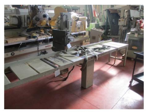
**Descrizione**: TRONCATRICE A PENDOLO OMGA MOD. SP500F - a norme CE - motore kw 4 - diam. max lama mm. 500 f.30 mm. - diam. min lama mm. 490 f.30 mm.
