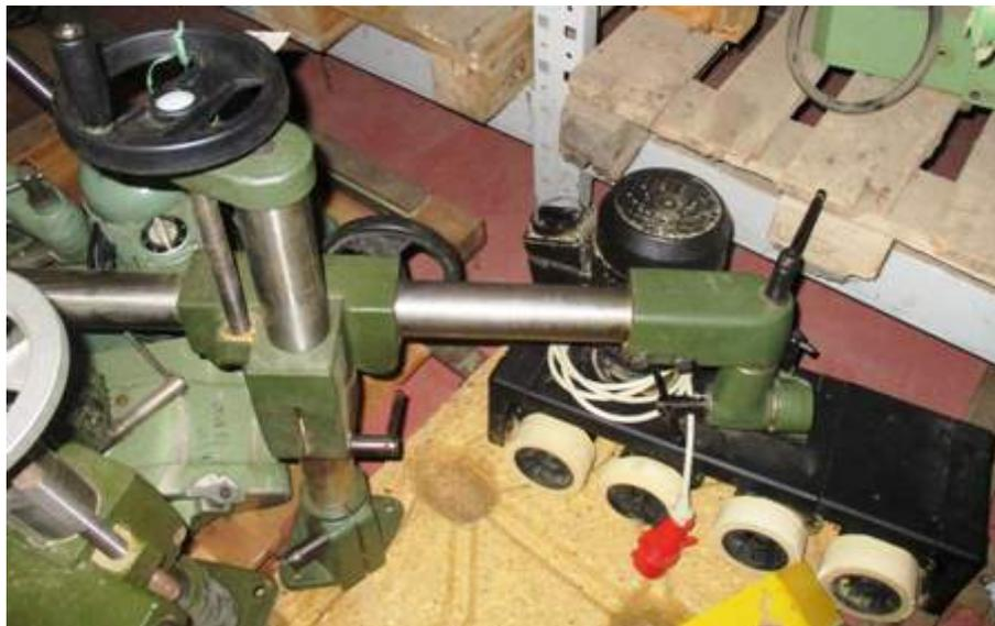
**Descrizione:** TRASCINATORE 4 RUOTE - 2 velocità trifase kw 0,6
