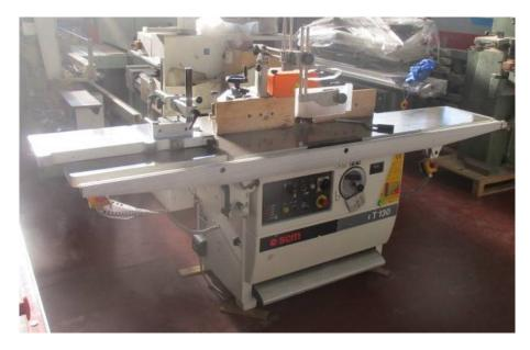
**Descrizione**: TOUPIE SCM MOD. T130N - versione TL - a norma CE - utensile a profilare max diam. 250 mm. - utensile a tenonare max diam. 300 mm.
