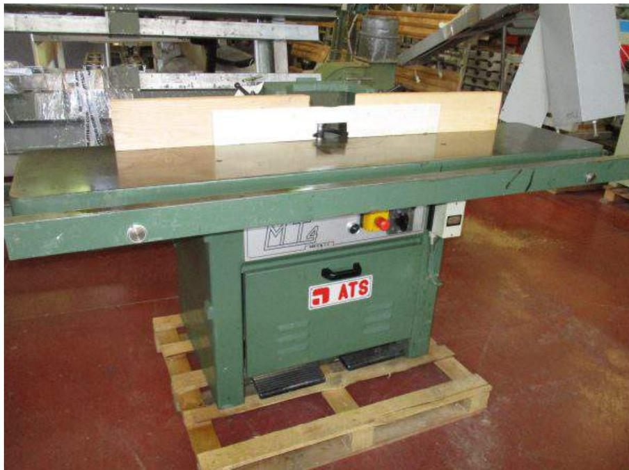
**Descrizione:** Toupie Magic mod. MT4 - piani lunghi mm. 1900 - albero fisso diam. 35 - utensile rientrabile sotto il piano diam.450 - bloccaggio albero a pedale - freno a pedale - sollevamento manuale dell'albero - n.4 velocità 3000-4500-7500-10.000 - inversione di rotazione, avviamento 0 stella triangolo
