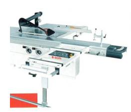
Secondo telaio con supporto di scorrimento su rotaia. Facilita notevolmente le operazioni di taglio di pannelli grandi e pesanti.
