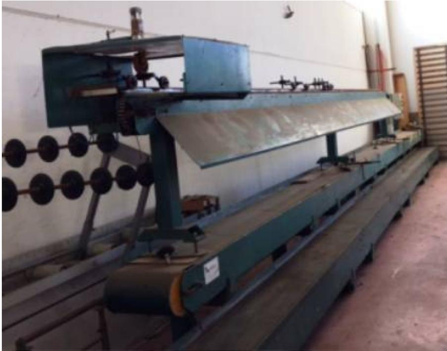
**Descrizione:** TAPPETO PLAN larghezza mm. 400 - lunghezza mt. 11,70 tappeto inferiore di raccolta - tappeto superiore lunghezza mt. 10,50 larghezza mm. 400 - selezionatore di scarico lunghezza mt. 7 con n.10 galoppini - quadro di comando
