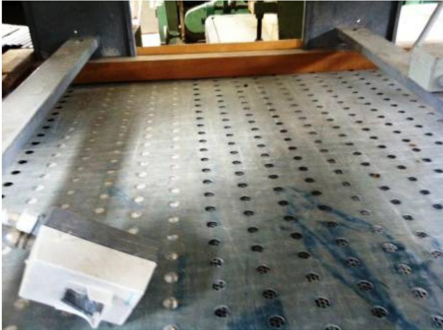
**Descrizione:** TAPPETO FORATO MOTORIZZATO SORBINI MOD. TRANSERT 35 B - a norme CE - da mm. 3500x1400 - motore kw 0,8 v380 - con cassetto di pulizia - avanzamento con motovariatore
