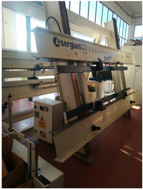
**Descrizione**: STRETTOIO SCM SERGIANI MOD. SM-K 30-20 - dimensioni max di lavoro 3000x2000 mm. - dimensioni min di lavoro 250x350 mm. - spinta verticale max 14 ton. - spinta orizzontale max 6 ton. - diam. cilindri/stelo orizzontali mm. 60/45 - corsa cilindri orizzontali mm.1200 - diam. cilindri/stelo verticali mm. 90/45 - corsa cilindri verticali mm. 1100 - altezza di
