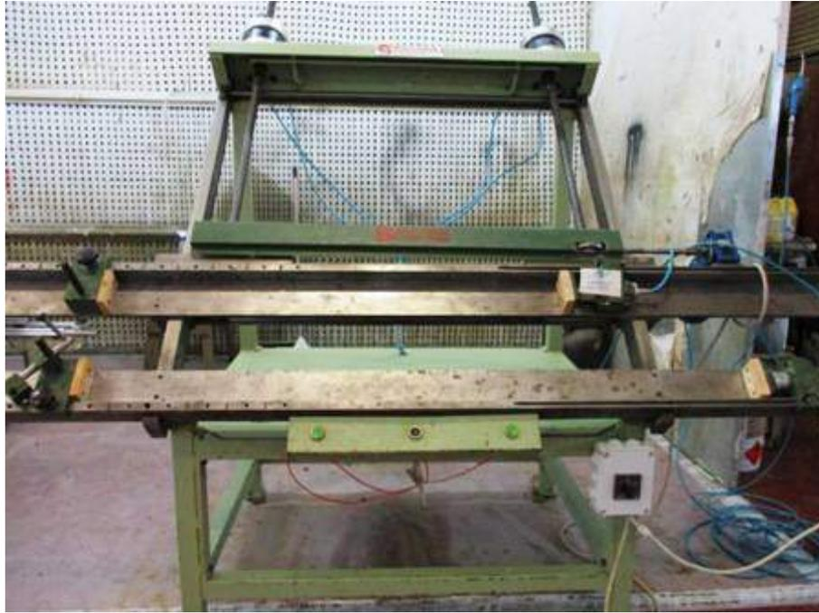
**Descrizione:** STRETTOIO PER ANTINE STROMAB MOD. STA 2500 - larghezza mm. 1200 - lunghezza mm. 2500 - spinta max a 8 bar 2500 mm. - movimentazione laterale motorizzata e chiusura dall'alto motorizzata
