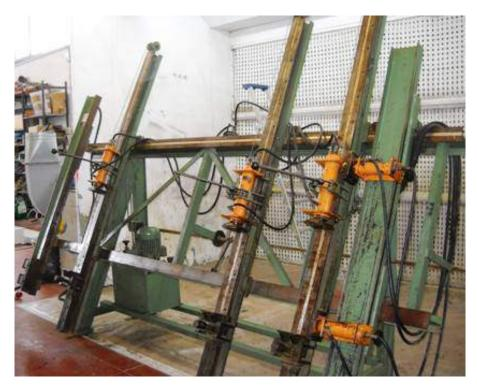
Descrizione: STRETTOIO MARZANI MOD. PV-12 - 3000x1500 - 3 montanti - idraulico
