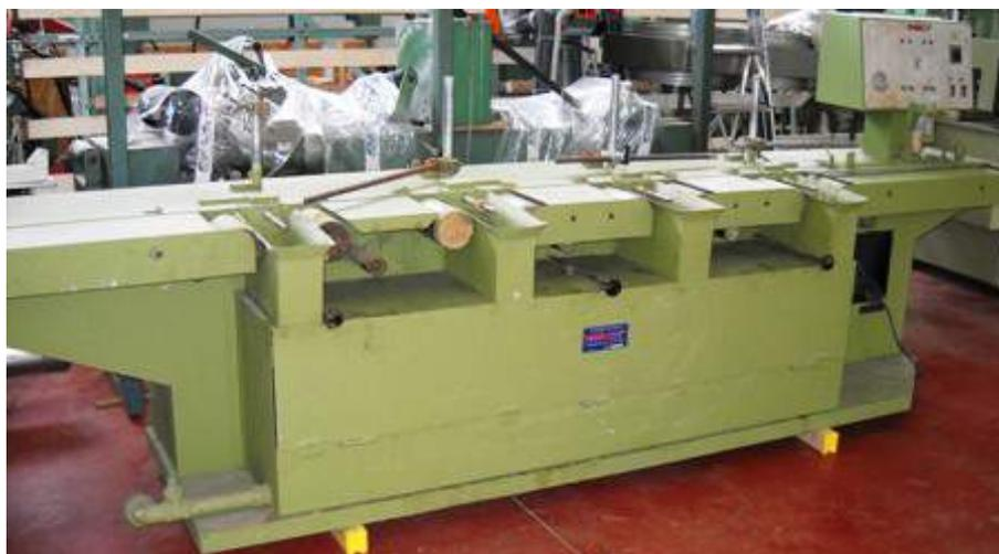
**Descrizione:** SPRUZZATORE MAKOR - n.4 teste senza pistole e pompe - con nastri trasportatori
