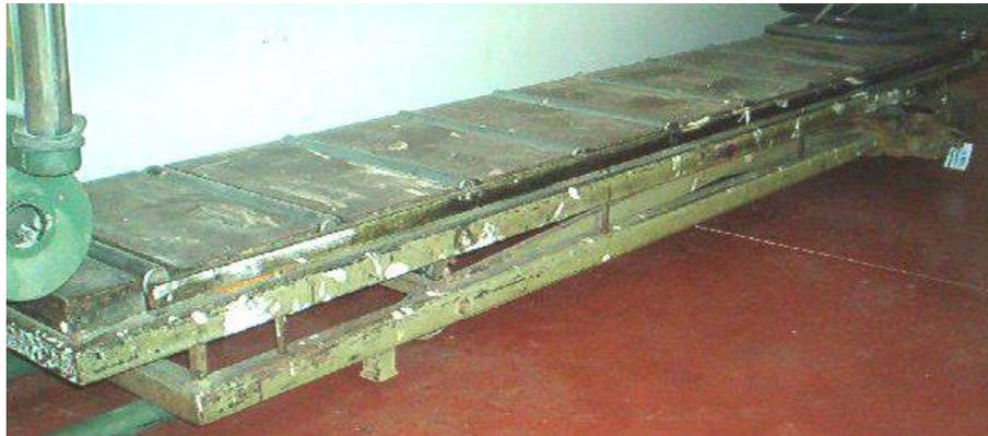
**Descrizione:** SOLLEVATORE CON RULLIERA CASSIOLI MOD.21 - dimensioni mm. 500x2700 - regolabile - idraulico
