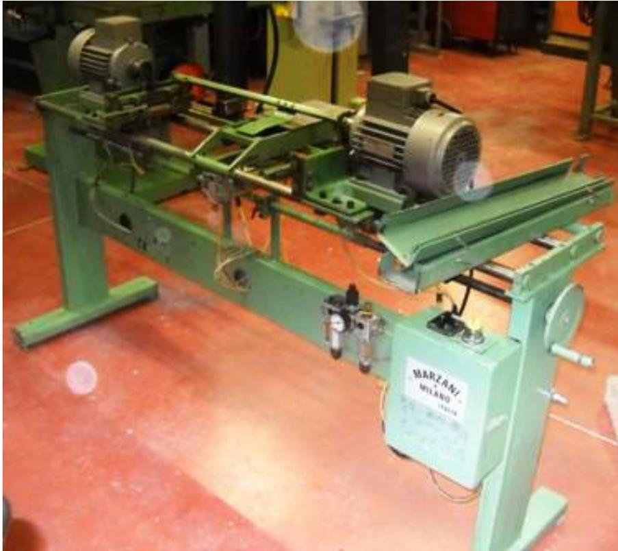
**Descrizione:** SMUSSASTECICHE MARZANI - due teste - funzionamento a raspa - spostamento teste manuale - potenza motore hp. 0,75 per ogni testa - apertura mm. 900
