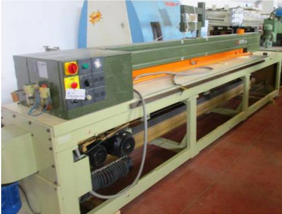
**Descrizione:** SEZIONATRICE SCM MOD. Z32 - trifase Dati tecnici: - lunghezza utile di taglio mm. 3050 - altezza max di taglio con diam. lama principale mm. 350 mm. 80 - profondità utile di taglio per tagli longitudinali con spintore manuale mm. 1300
