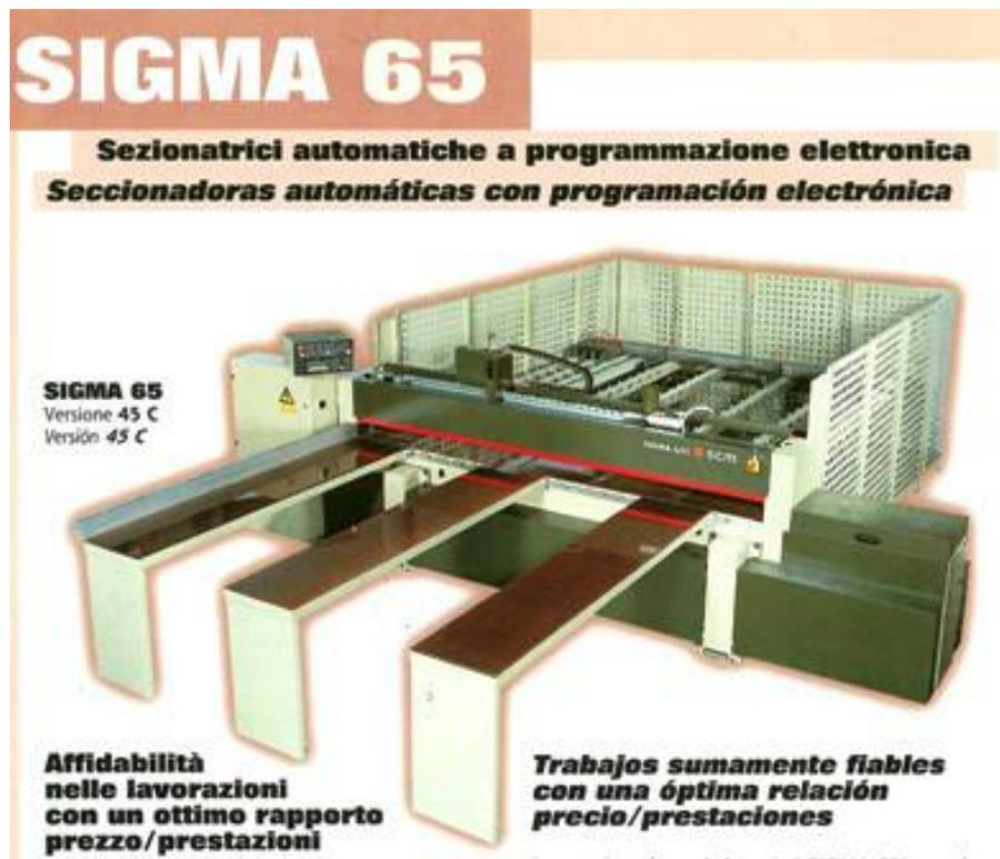
**Descrizione:** SEZIONATRICE SCM MOD. SIGMA 65 - comprensiva di spintore ma senza pinze - mm. 4500x3200 mm. Dati tecnici: - sporgenza max lama mm.65 - potenza motore lama kw 5,5 - potenza motore incisore kw 1,5 - diam. max lama mm. 300 - diam. max incisore mm. 160 - diam. min. lama mm. 250 - larghezza min.del pezzo prodotto dal taglio longitudinale mm. 15
