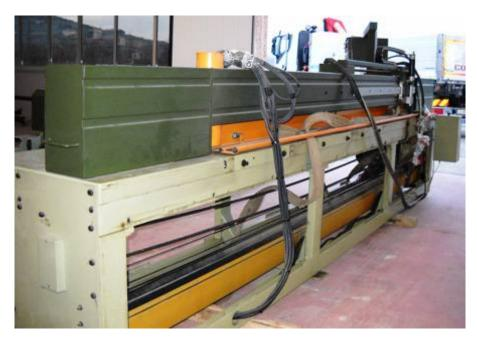
**Descrizione**: Sezionatrice Scm mod. ALFA45C - a normative CE - profondità di taglio mm. 3500 - n.2 pianetti a velo d'aria mm. 1500 - n.1 pianetto a velo d'aria mm. 2500 - n.8 pinze
