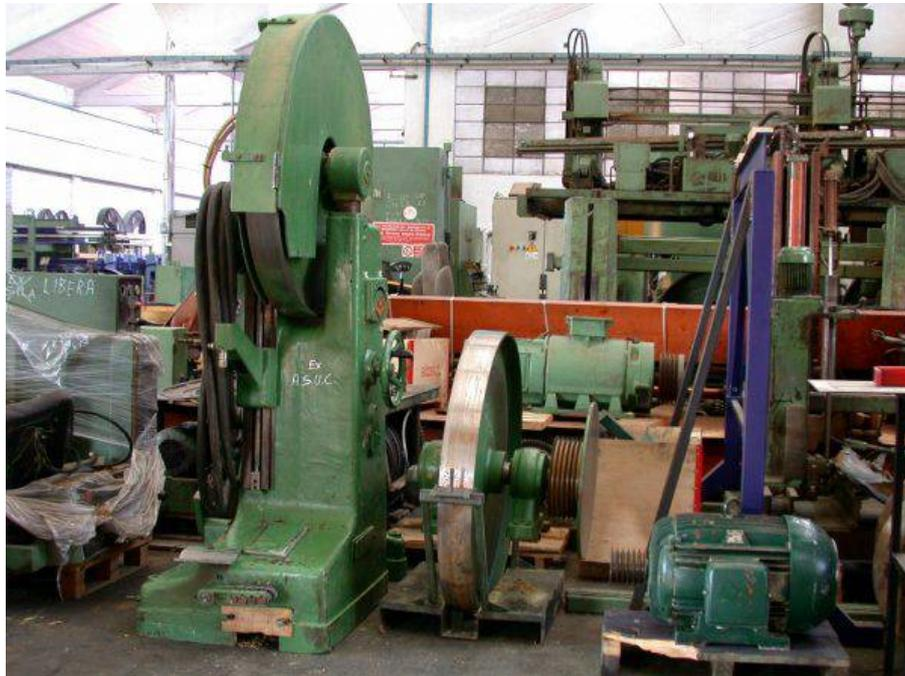
**Descrizione:** SEGA TRONCHI PRIMULTINI MOD. SE-CEA-IEA da 1100 - senza CE - sinistra - mt.15 di binario - motore hp 40 - fascia volani mm.120 - sollevamento gruppo lama motorizzata - carro a 4 morse con chiusura manuale - completo di binario - divisore per spessori elettrico - avanzamento e ritorno del carro con cremagliera
