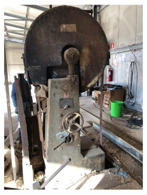
**Descrizione**: SEGA TRONCHI PRIMULTINI TIPO NV 200 L4 - volani da 120 - 4 morse elettriche - spostamento ganci manuale - gira antiorario - motore hp 40 Completa di: - corpo macchina - volano sotto - motore - vagone - affilatrice - affilatrice - misura dei binari: mt.3 x n.12 pezzi **Marca**: Primultini
