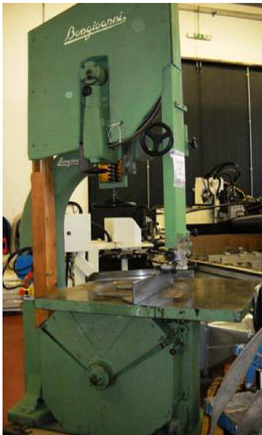
**Descrizione:** SEGA NASTRO BONGIOANNI - da mm. 900 - potenza motore kw7,5 HP10 - volani pieni
