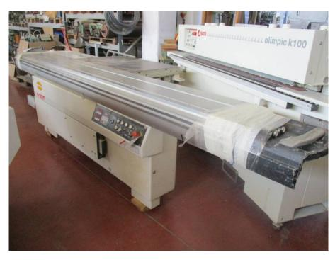
**Descrizione**: SEGA CIRCOLARE SCM MOD. SI350 E - carro da mm. 3200 - a norme CE - pulsanti marcia/arresto integrati nel carro scorrevole - guida a squadrare "quick look" con rullo esten. - guida parallela con posizionatore elettronico - diam. albero sega 30 mm
