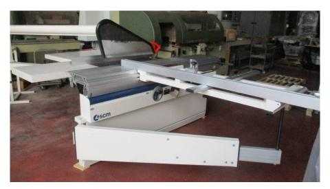
**Descrizione**: SEGA CIRCOLARE SCM MOD. CLASS SI 300 - a norme CE Composta da: - configurazione macchina per la lavorazione di materiali EXTRA-LEGNO - dispositivo di microlubrificazione della lama per la lavorazione di materiali plastici e leghe leggere in alluminio e ottone - protezione alle lame di tipo sospesa - SPECIALE MANTIS con carro 2200 mm.
