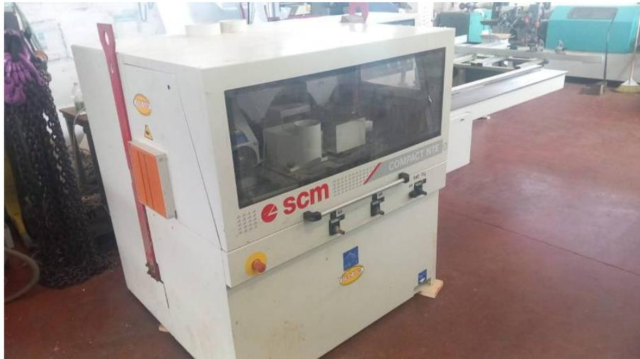
**Descrizione:** SCORNICIATRICE SCM MOD. COMPACT NTE - a norme CE COMPOSIZIONE: 1) ALBERO PIALLA ORIZZONTALE INFERIORE 2) VERTICALE DX 3) VERTICALE SX 4) ORIZZONTALE SUPERIORE - freni motore - variazione traino inverter - pressione pneumatica - piano mm. 2500 - kit per larghezza min. di lavoro
