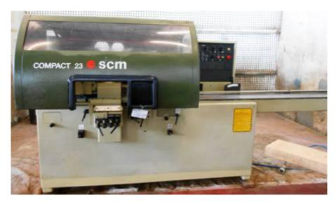
**Descrizione**: SCORNICIATRICE SCM MOD. COMPACT 23 - massima larghezza utile di lavoro (sezione finita) mm. 230 (con utensile diam. mm. 140 su verticale sx) - massima altezza utile di lavoro (sezione finita) mm. 125 - lunghezza utile alberi orizzontali mm.245 - lunghezza utile alberi verticali mm. 140 - diam. in.utensili per profilare mm. 100 - diam. massimo utensile per profilare mm. 180
