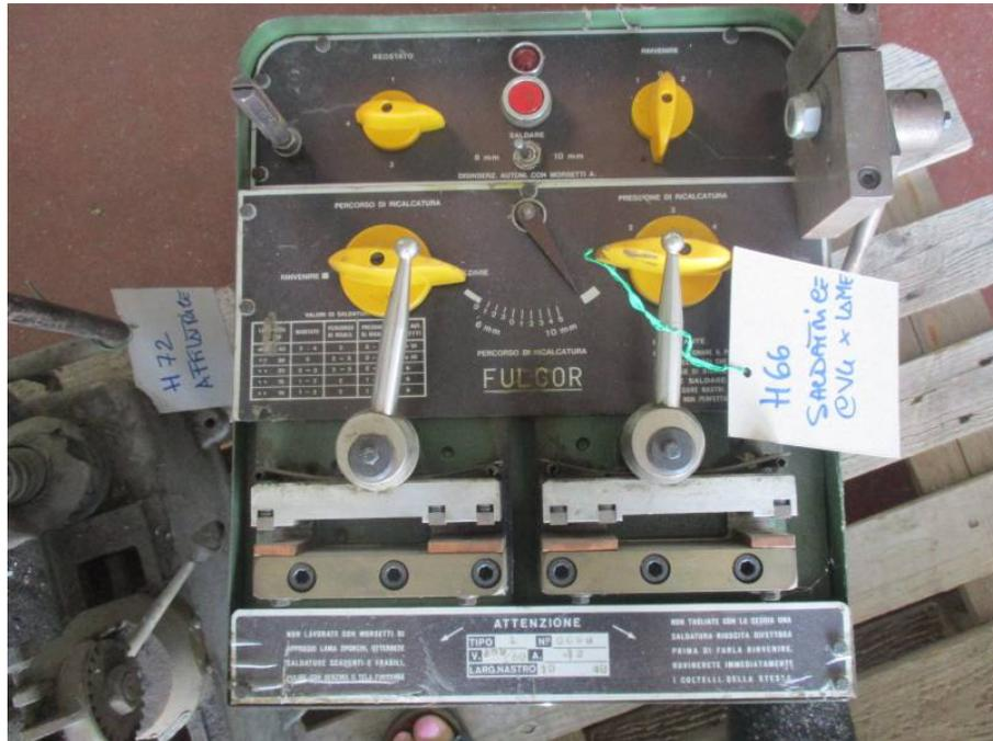
**Descrizione:** SALDATRICE PER LAME VISCAT TIPO 4 - larghezza nastro 10 - 40 - V. 380/50
