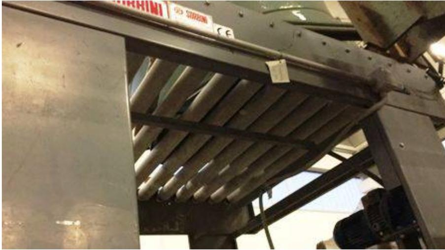
**Descrizione:** RULLIERA MOTORIZZATA MOD. TRANSFER T 20 R - a norme CE - dimensioni larghezza mm. 1530 (utile mm.1420) x lunghezza totale mm. 2000 - altezza con piedino cm. 91 - altezza senza piedino cm. 86 - motore kw 0,4 v380/50 - n.8 rulli al mt. (per un totale di n.16 rulli) diam.80 interasse 22,5 lunghezza mm. 140 - lunghezza da rullo a rullo cm. 194
