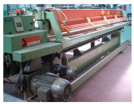
**Descrizione**: REFILATRICE STROMAB mod. RF 310 - lunghezza mm. 3100 - n.2 piani appoggio post. - motore lama hp5,5 - motore incisore hp 0,75 - diam. lama 180 mm. - diam. foro lama 20 mm. - giri lama g/min 9000 - altezza di taglio registrabile con lama diam. 180 mm. da 0 a 45 mm. - altezza di taglio registrabile con lama diam. 200 mm. da 0 a 55 mm. - larghezza max rifilatura mm. 1300 - larghezza min rifilatura mm. 25 Dimensioni d'ingombro: mt. 4,80x2,20
