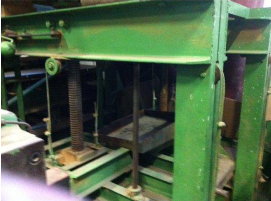
**Descrizione:** PRESSA 2500x1200 - piani in legno - discesa meccanica - piano superiore sezionato in 3 pezzi: \*1° mm. 640x1200 \*2° mm.1070x1200 \*3° mm. 860x1200
