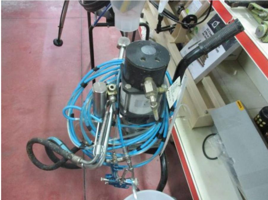
**Descrizione:** POMPA DI VERNICIATURA COLORA MISTO ARIA AD ACQUA MOD. AERMIX - a normative CE Revisionata.
