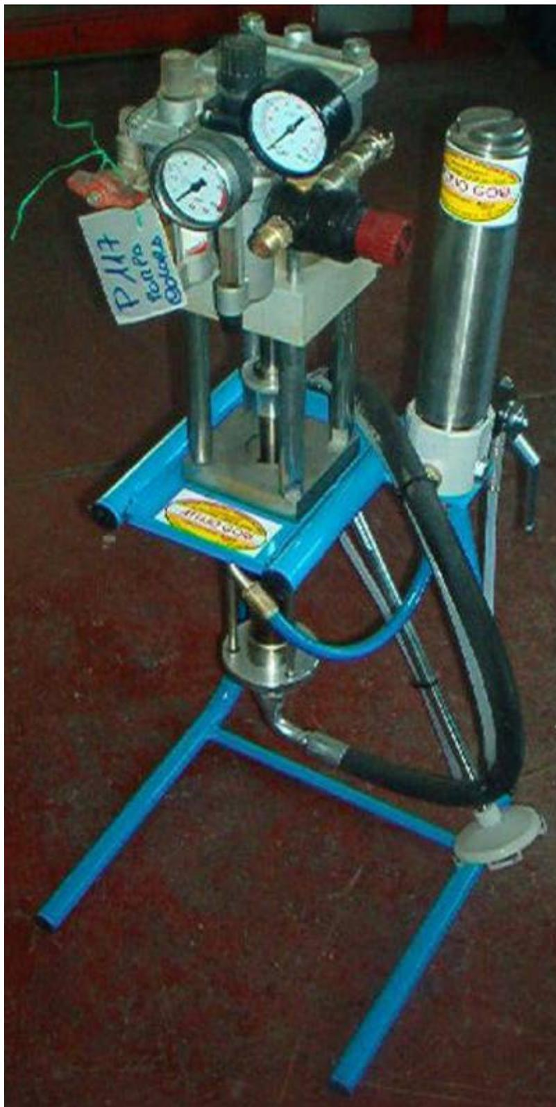
**Descrizione:** POMPA COLORATECNI MOD. T201 - rapporto di pressione 20-1 - portata max l/m 2,5 - pressione aria bar 2%8 - gr.filtro regolatore. lubrificatore, manometro e rubinetto dell'aria - pescante con filtro - valvola e tubazione di ricircolo - tubazione e pistole escluse REVISIONATA
