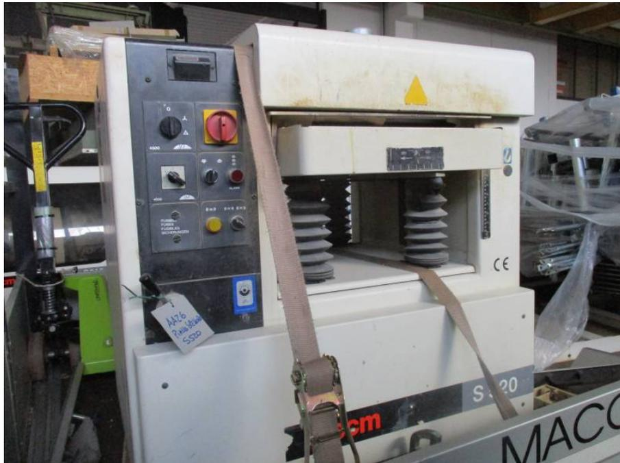
**Descrizione:** PIALLA A SPESSORE SCM MOD. S 520 - a norme CE - piano a spessore con n.2 rulli
