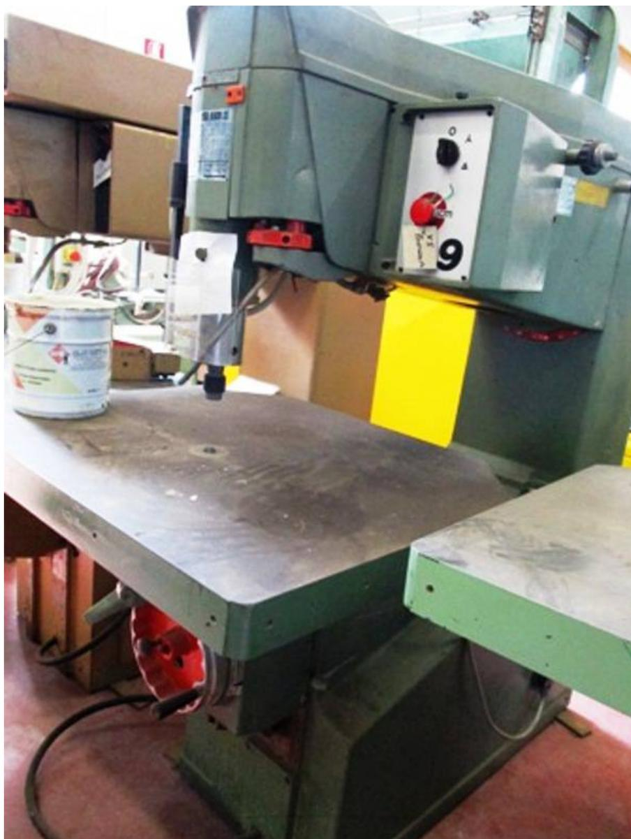
**Descrizione:** PANTOGRAFO SCM MOD. R9 Caratteristiche tecniche: - testa flottante - distanza fra albero e montante mm.915 - velocità albero 10000- 20000 giri/min. - motore hp 5,5 - corsa verticale albero mm.110 - corsa verticale piano mm.200 - max distanza fra piano e mandrino mm.310 - n.6 battute registrabili - dimensioni del piano mm.905x770 - inclinazione albero fino a
