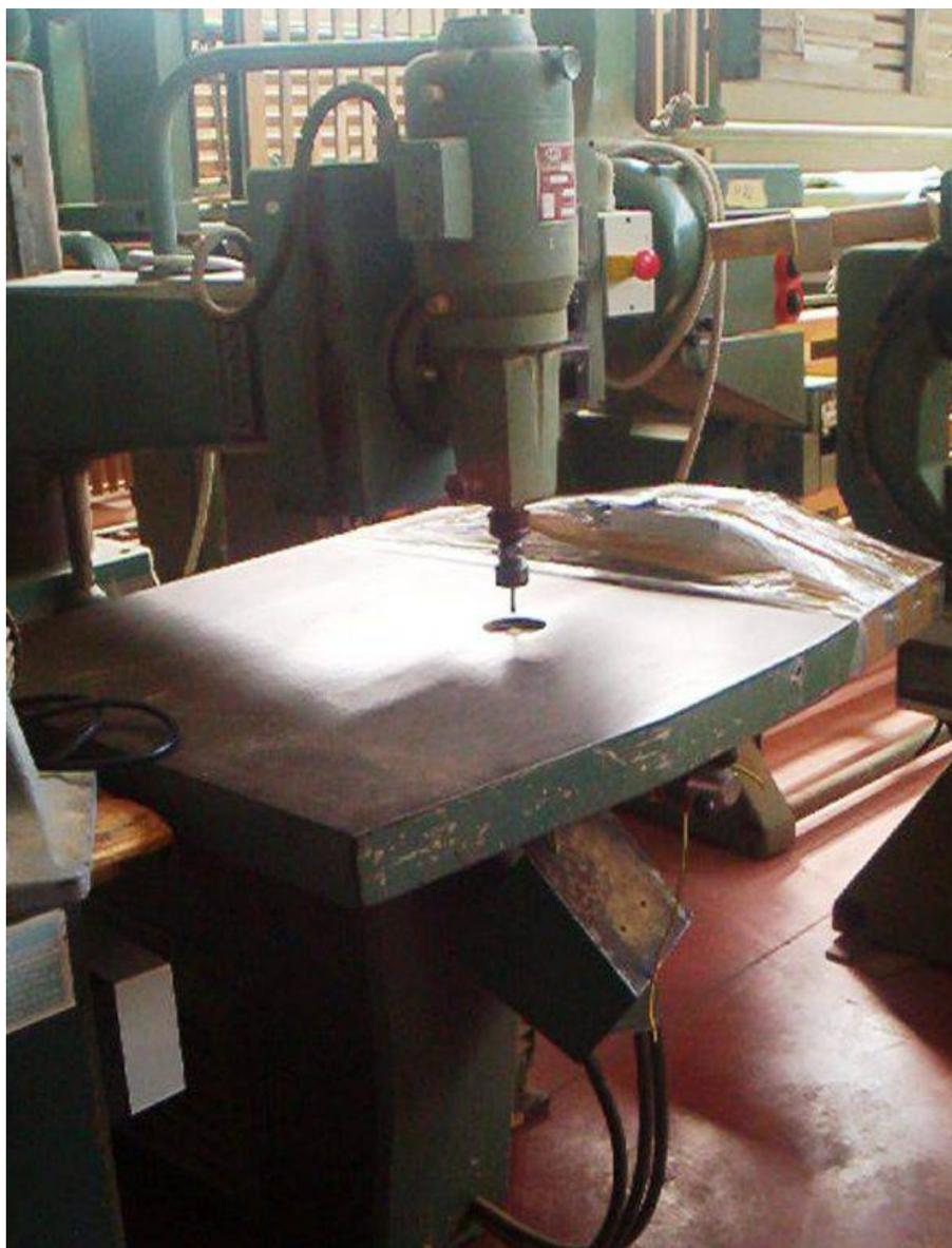
**Descrizione:** PANTOGRAFO PFEIL MOD. HF723 - con convertitore - sbraccio 850 mm. - motore hp 4,5 - v110-160 - giri 12000-18000
