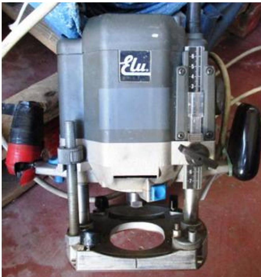
**Descrizione:** PANTOGRAFO MANUALE MOD. MOF 131-QS - a norma CE
