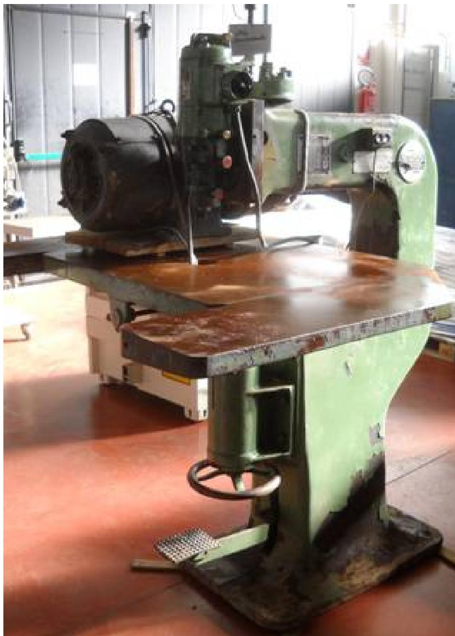
**Descrizione:** PANTOGRAFO Ofec - discesa meccanica - potenza motore hp 1,5 monofase
