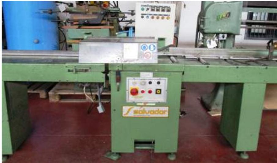
**Descrizione:** OTTIMIZZATRICE SALVADOR MOD. TVB/400 - a normative CE - potenza installata kw 3 - dimensione lama mm. 400 - sezione di taglio mm. 250x80 - Dimensioni di ingombro: \*larghezza mm. 920 \*lunghezza mm. 6230 \*altezza mm.1400
