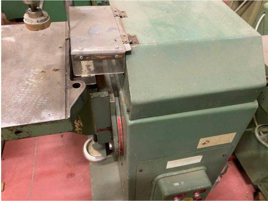
**Descrizione:** MORTASATRICE PADE MOD. MSO - semplice aut.ca oscillante (avanzamento della tavola - punta oscilla) - n. 1 punta - carico e scarico manuale
