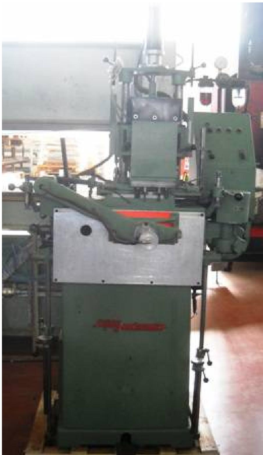
**Descrizione:** MORTASATRICE CIPSY AUTOMATIC - per porte - 4 punte verticali - 2 punte orizzontali
