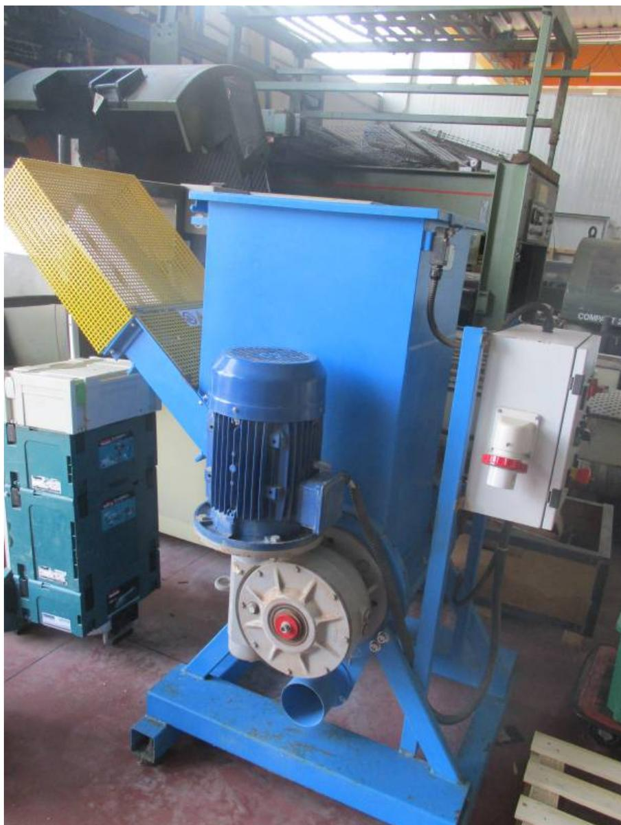
**Descrizione:** MACINATORE POR MOD. BRUCO N - a normative CE Caratteristiche tecniche: - frontale mm. 900 - profondità mm. 1630 - altezza mm. 1510 - apertura bocca mm. 420x540 - motore hp 7,5 - con griglia diam. 20 kg/h. 40/60 ( produzione teorica con materiale di falegnameria. La produzione è subordinata al tipo di materiale e di pezzatura)
