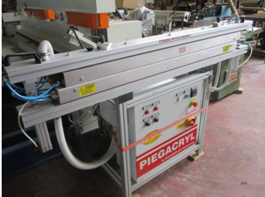
**Descrizione:** MACCHINA RISCALDANTE PER PIEGATURA LASTRE TERMOPLASTICHE MALCOMPLAST MOD. PIEGACRYL - normative CE - indicata per la piegatura di lastre di elevato spessore sino a 15-20 mm. - raffreddamento ad acqua - lunghezza utile lavoro mm.1240 - alimentazione elettrica 220/380 volt - alimentazione pneumatica 5 atm - larghezza zona riscaldata 8-80 mm. - regolazione in altezza delle resistenze +-8mm.
