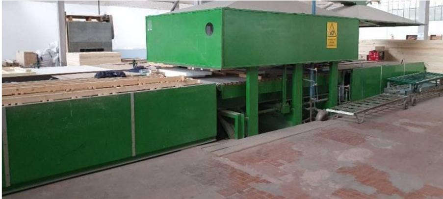
**Descrizione:** Linea di pressatura marca FAMA Dimensioni: \*caricatore lunghezza mm. 4280 mm. \*la pressa utile 3340x1800 mm. - riscaldamento a vapore o acqua calda, - piani massicci - piano ingresso 4100x1800 mm. - piano uscita 4100x1800 mm. - scaricatore 4250 mm. - n.6 cilindri di spinta dal basso verso l'alto - peso q. 120 - la carenatura sopra è stata fatta fare dall'ASL, carter aspirazione per evacuazione vapori - pronta per il carico
